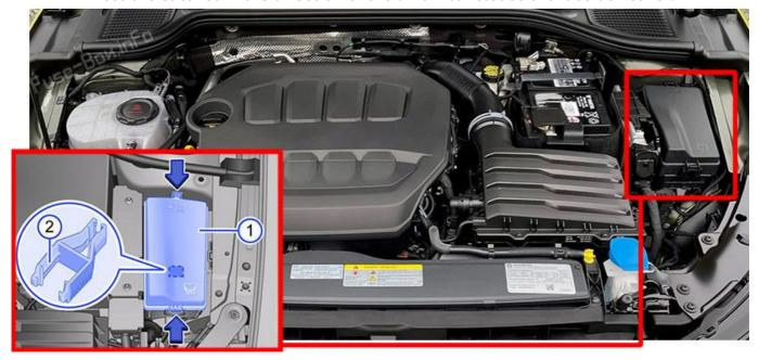
Fuse Box Diagram (Fuse holder B -SB-)
